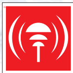
F12-01 Пункт извещения о пожаре
