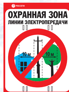
Охранная зона ЛЭП 6-15 кВ – 10 метров 300x400 мм
