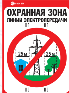
Охранная зона ЛЭП 220 кВ – 25 метров 400x550 мм
