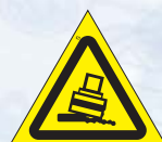
W24 Осторожно. Возможно опрокидывание
