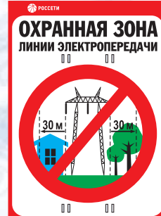
Охранная зона ЛЭП 330 кВ – 30 метров 400x550 мм
