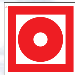
F10 Кнопка включения установок (систем) пожарной автоматики
